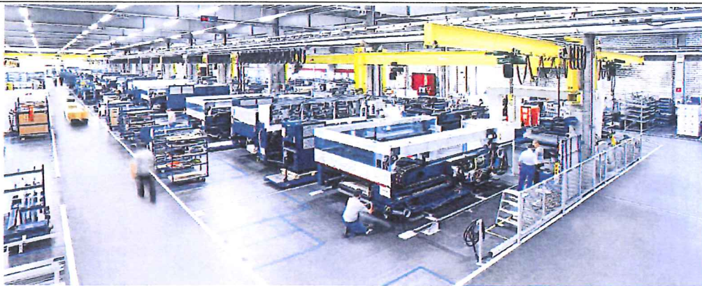
Blick in die Montagehalle der Trumpf Maschinen Grösch AG: Die Laserschneidmaschinen werden in Fließmontage mit taktgenauer Beschaffung und Logistik produziert. Trumpf zählt in diesem Bereich zu den Weltmarktführern. (ZVG)
